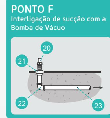
➔ Interligação dos pontos "F" caixa de ligação e Bomba de Vácuo
