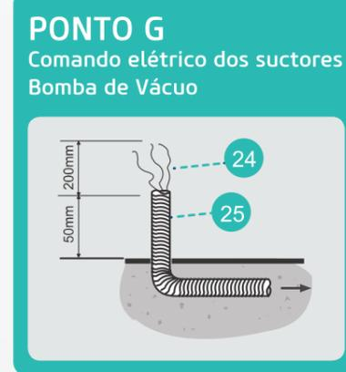
➔ Interligação dos pontos "G" caixa de ligação e Bomba de Vácuo
