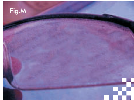
Fig.M Óculos do operador. Fotografia tirada com aumento da luz roxa para evidenciar os depósitos na superfície da lente.
