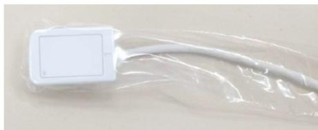
O sensor pode ser posicionado manualmente ou utilizando posicionadores intraorais. Em caso de posicionamento manual, introduza o sensor na boca do paciente e posicionando de maneira mais posterior possível.
