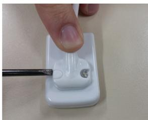
Com a chave de fenda de ponta 3 x 0,8 mm remover os parafusos de fixação do cabo.
