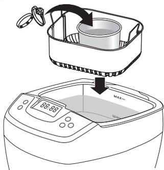
Coloque os objetos em um recipiente separado. Utilize ondas ultrassônicas para penetrar o recipiente e realizar a limpeza. Locais apropriados: Lojas de impressão, assistência técnica de telefones móveis e eletrônicos.
