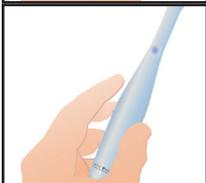
Modo Semi-automático: Led Magenta. Toque em um dos botões e a câmera buscará o foco. Aguarde a focalização e, para capturar e armazenar a imagem, toque novamente e mantenha pressionado por 2 segundos um dos botões
