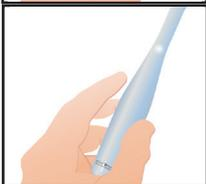
Modo Macro: Led Branco Piscante. Para capturar imagens com zoom de 50x, posicione a câmera a uma distância de 8mm do alvo desejado, mantenha a posição fixa e, quando a imagem estiver focada, toque em um dos botões para capturar e armazenar sua foto.
